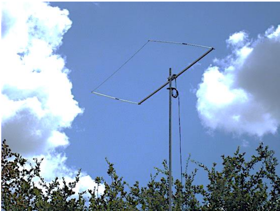
Figure 20 - Par Electronics 6m Stressed Moxon
