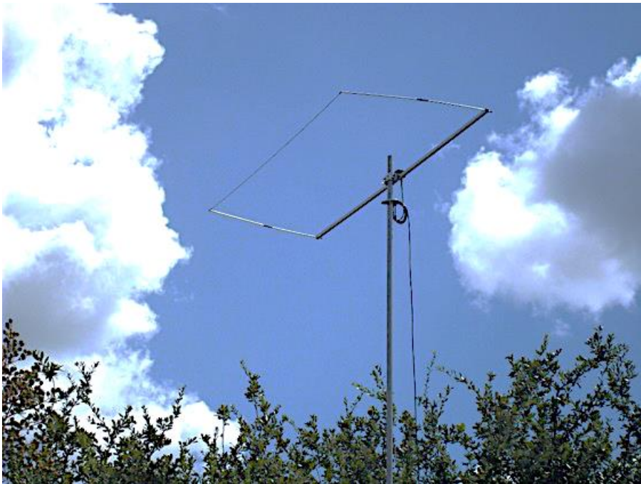
Figure 21 - Par Electronics 6m Stressed Moxon
